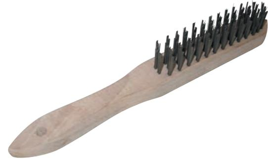
Metallbürste zum Reinigen der Eisen.
